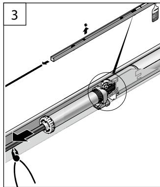
Retirez l'axe d'enroulement latéralement de la tête du moteur.
