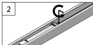
Desserrer les arrêts de l'axe d'enroulement.
